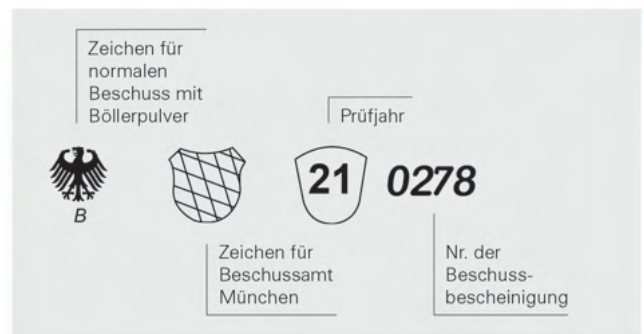
Abb. 10: Beispiel für die Kennzeichnung eines Böllergerätes
