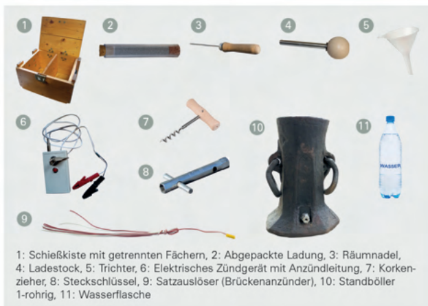
Abb. 51: Einrohriger Standböllern mit elektrischer Anzündvorrichtung, Zubehör
